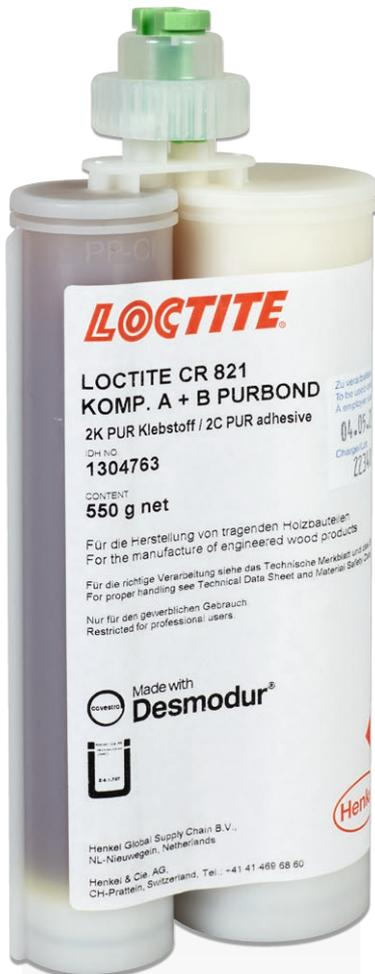
Spezieller nicht schäumender 2K Polyurethanklebstoff für die Herstellung von tragenden Holzbauteilen der Nutzungsklasse 1, 2 und 3 nach EN 1995-1-1. Für die Verankerung und für die Einleitung von Zug- und Druckkräften mittels Gewindestangen und Betonrippenstählen in Ingenieur-Holzbauteilen längs und / oder quer zur Faserrichtung. Frei von Lösemitteln und Formaldehyd mit guter Beständigkeit gegen schwache Alkalien, Säuren und Lösemittel.
