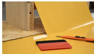
3. Weitere Bahnen überlappend anbringen um eine vollflächige Verklebung zu erstellen.
