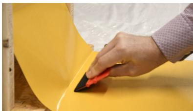
2. Fläche glattstreichen um eingeschlossene Luft zu entfernen, Falten sollten vermieden werden.
