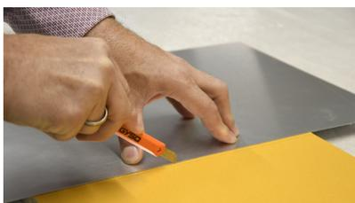
4. Überlappungen sowie überschüssiges Material an den Seiten entfernen.
